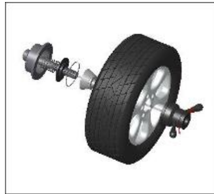
Основной вал – соответствующий конус (широким диаметром вовнутрь) — колесо—быстрозажимная гайка
